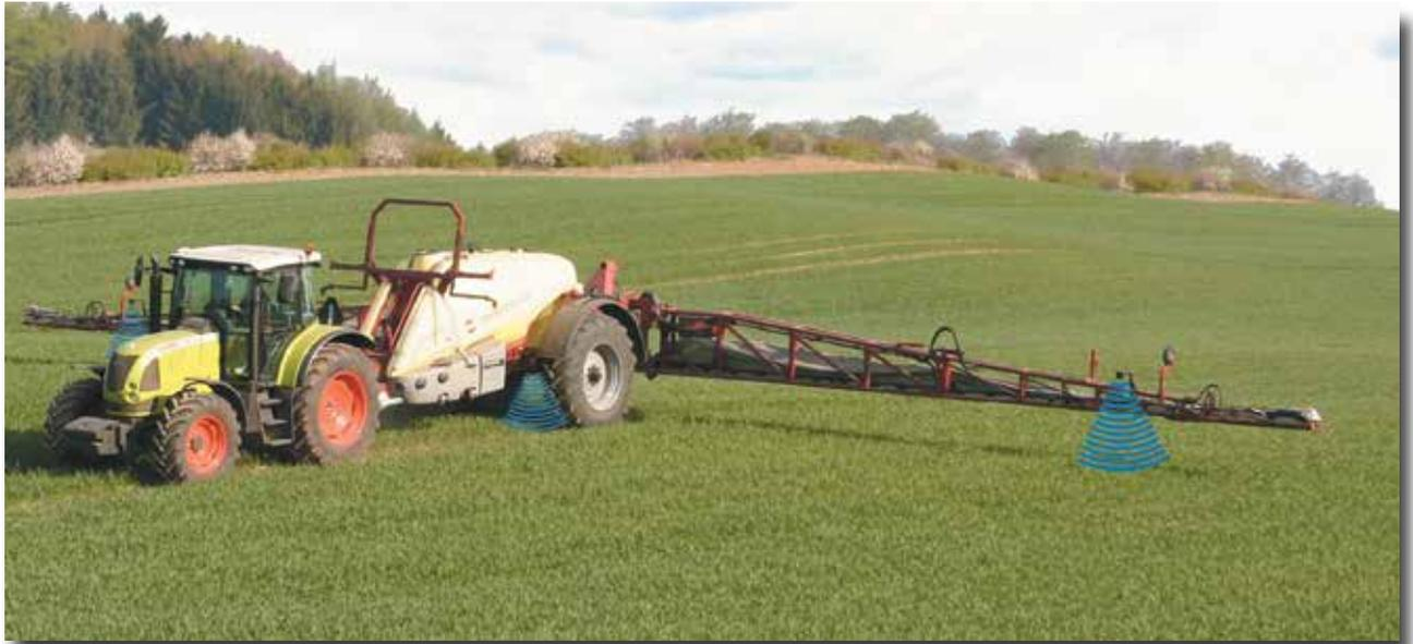
Die NORAC-Spritzhöhenführungssysteme nutzen in der linken und rechten Teilbreite sowie in der Gestängemittelteilbreite montierte Ultraschallsensoren, um den zuvor eingestellten Abstand des Gestänges über dem Boden oder den Pflanzen automatisch beizubehalten.
